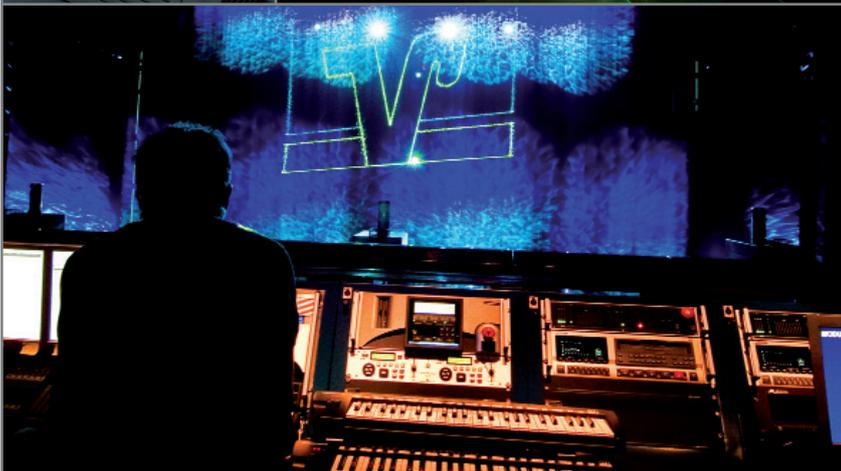
Dabei können sparks® Laser extrem helle und spektakuläre Projektionen auch auf sehr große oder auch gewölbte Flächen wie z. B. Gaskesseln, Schnee oder gigantischen Satellitenschüsseln realisieren. Möglich wird dies vor allem durch das von LOBO entwickelte PCS (Post-Collimated Scanning) Verfahren, das das Laserlicht selbst über große Distanzen in einen besonders dünnen und damit sehr hellen Strahl bündelt.
